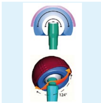
Abb. 4: Prinzip der doppelten Mobilität im „Duokopf-System“ im Falle der Hüftgelenksrevisionschirurgie mit deutlich verbesserter „Range of Motion“ und erhöhter Luxationsicherheit. Monoblock-Pfanne aus Metall, großem Liner aus Polyethylen und Prothesenkopf aus CoCr oder Keramik (22,2 oder 28mm) (Avantage-System, Firma Biomet Deutschland GmbH)
